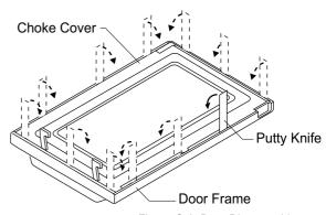
Figure C-6. Door Disassembly
