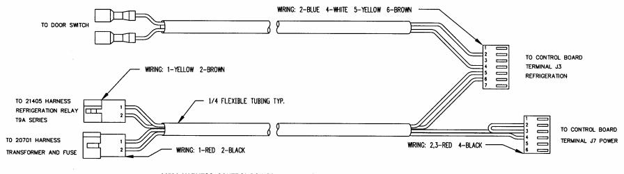
21591, HARNESS, CONTROL POWER AND REFRIGERATION RELAY, LEFT SIDE DOOR SWITCH, SENSIT II
